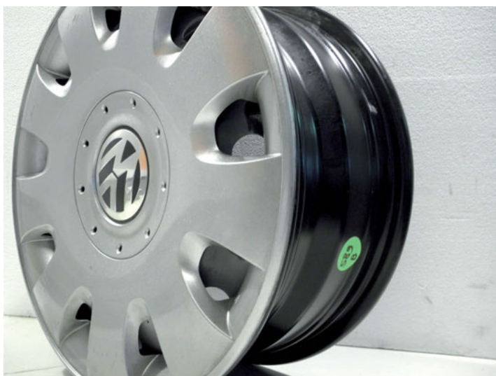
10 namísto 20 ventiláčnických otvorů a nesoulad mezi umístěním ventiláčnických otvorů na kole a poklici vede k přehřívání brzd.
