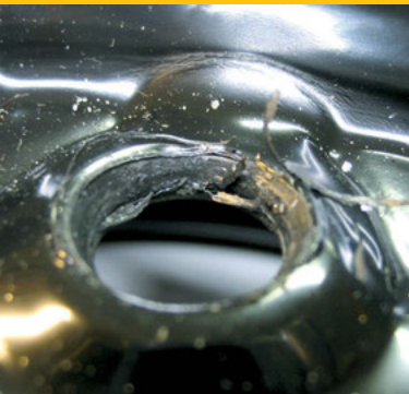
Uvolnění šroubů kvůli příliš silné vrstvě laku
