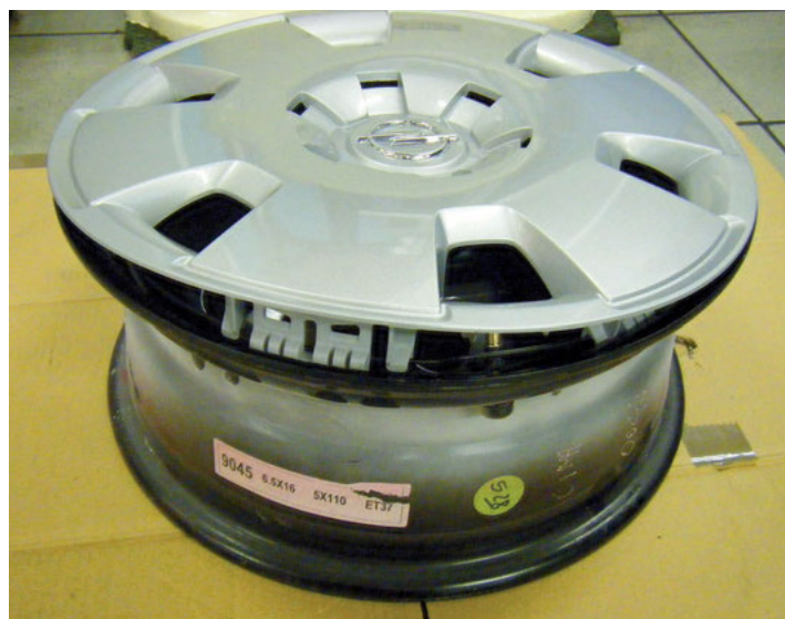
Další problém: kryty kol nedosednou kvůli odlišnému profilu ráfku.
