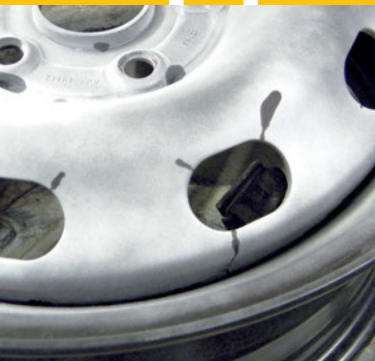
Předčasné prasknutí kola při zátěžovém testu
