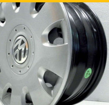
Přehřívání brzd kvůli menšímu počtu ventilačních otvorů
